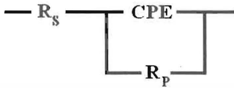
ภาพที่ 4.36 แสดงวงจรสมมูลที่ใช้ในการจำลองหาค่าอิมพีแดนซ์เชิงซ้อน
