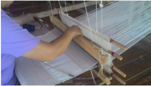
ภาพที่ 4.9-4.10 แสดงการทอผ้าด้วยกี่กระตุก ด้ายยืนเป็นฝ้าย 100 % สถานที่; ศูนย์ผ้าไทย ต.หาดเสี้ยว อ.ศรีสัชนาลัย จ.สุโขทัย ผู้ทอ นางประสิทธิ์ มาเวก อายุ 57 ปี ภาพโดย จุฑามาศ ช้อนนาค
