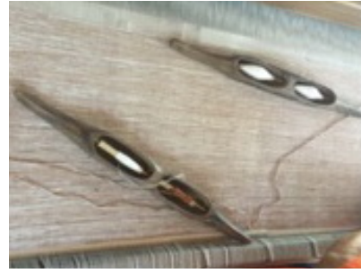
ภาพที่ 4.9-4.10 แสดงการทอผ้าด้วยกี่กระตุก ด้ายยืนเป็นฝ้าย 100 % สถานที่; ศูนย์ผ้าไทย ต.หาดเสี้ยว อ.ศรีสัชนาลัย จ.สุโขทัย ผู้ทอ นางประสิทธิ์ มาเวก อายุ 57 ปี ภาพโดย จุฑามาศ ช้อนนาค
