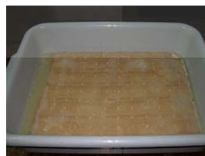
ภาพที่ 3.2-3.3 แสดงการทำทำความสะอาดผ้าใยตาลผสมใยไผ่ด้วยผงซักฟอกและการแช่ผ้าใยตาลผสมใยไผ่ในสารละลายชันสนและสารส้มแล้วนำไปปั่นในเครื่องซักผ้า 3,000 รอบ/นาที
