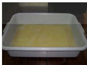
ภาพที่ 3.2-3.3 แสดงการทำทำความสะอาดผ้าใยตาลผสมใยไผ่ด้วยผงซักฟอกและการแช่ผ้าใยตาลผสมใยไผ่ในสารละลายชันสนและสารส้มแล้วนำไปปั่นในเครื่องซักผ้า 3,000 รอบ/นาที
