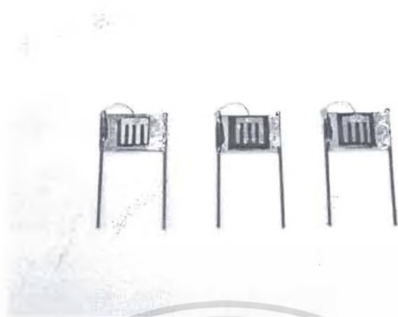
รูปที่ 4.39 แสดงภาพถ่ายของอุปกรณ์เซลล์แสงอาทิตย์ที่มีชั้นนาโนพอร์สซิกอนเป็นชั้นลดการสะท้อนแสงที่สร้างขึ้นได้
