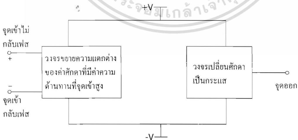
รูปที่ 1 บล็อกไดอะแกรมโครงสร้างพื้นฐานของโอทีเอ
