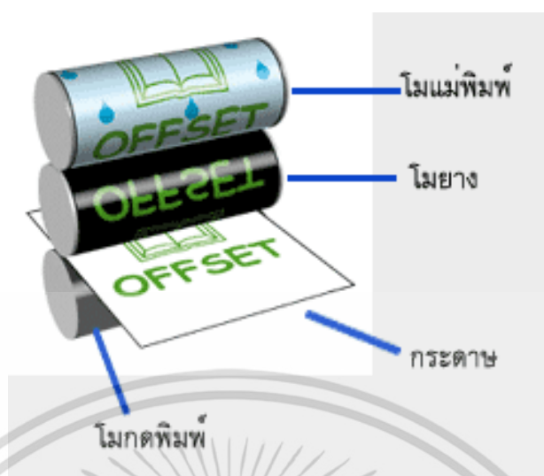
ภาพที่ 2.28 แสดงหลักการพิมพ์ในระบบ Offset ที่มา: PENPRINTING [Online], (2559)
