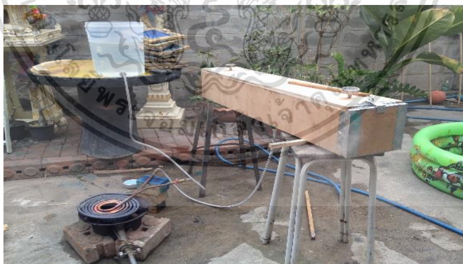
ภาพที่ 4.6 แสดงตู้อบไอน้ำรูปแบบไม้อัดภายในหุ้มแผ่นสังกะสี
