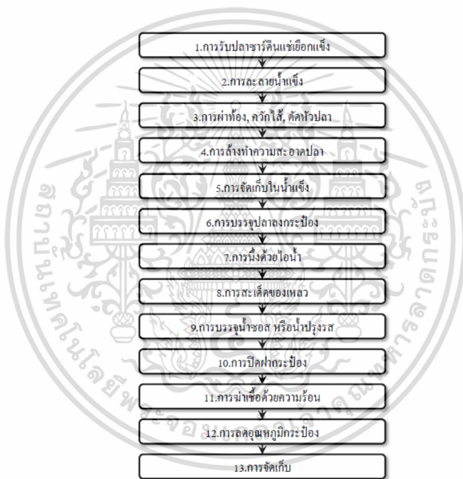
ภาพที่ 4.1 กระบวนการผลิตปลาซาร์ดีนบรรจุกระป๋อง
