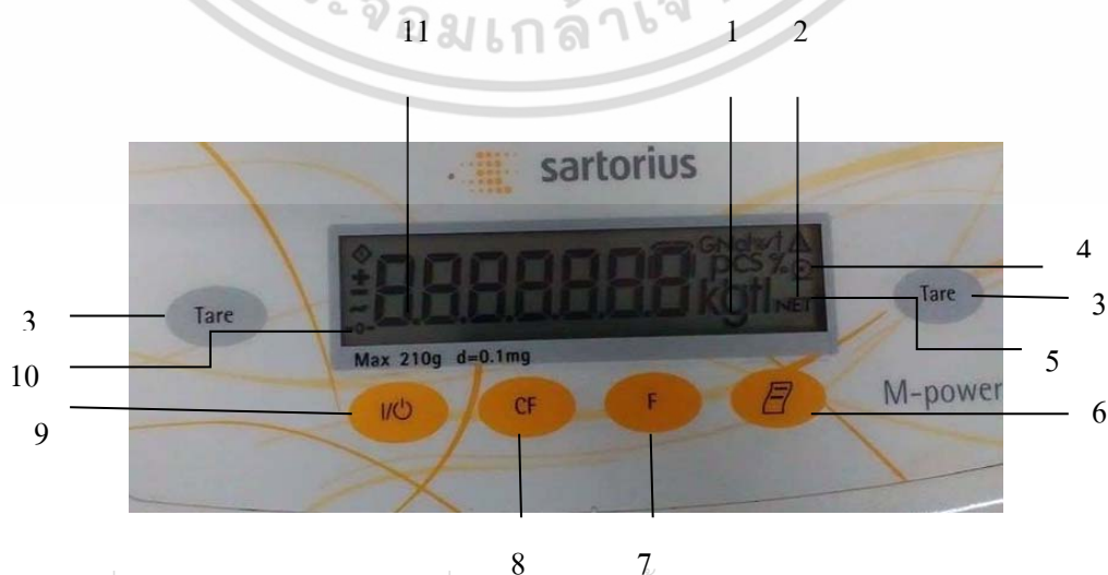
รูปที่ 3.9 เครื่องชั่งตวงวัด 4 ตำแหน่ง ยี่ห้อ Sartorius รุ่น AZ Series
