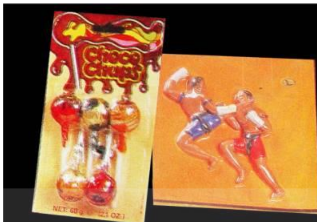
ภาพที่ 2.33 พลาสติกชนิดประชิดสินค้า (skin pack)
