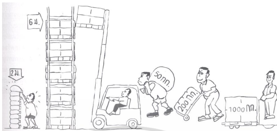
ภาพที่ 2.46 การใช้แท่นรองรับสินค้าและเครื่องจักรช่วยให้การขนถ่ายประหยัดและรวดเร็ว ที่มา : จากเว็บไซต์ www.crnfe.ac.th , 2555
