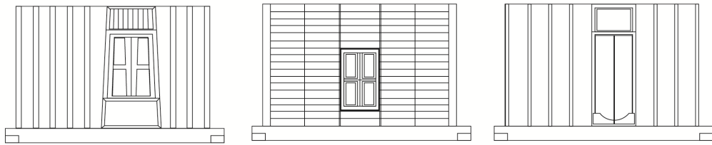
ป่องเอี่ยม (หน้าต่าง) แบบเก่าเปิดเข้าใน แบบใหม่เปิดออกนอก
