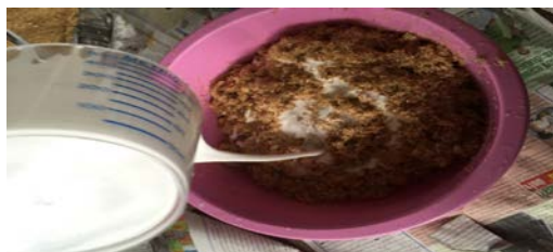
ภาพที่ 2.12 นำบล็อกที่เตรียมไว้มาวางบนโต๊ะ นำใยป่นจากกากกล้วยมาและเทด้วยกาวในอัตราส่วนที่ต้องการ
