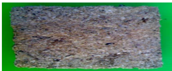
ภาพที่ 2.15 เมื่ออัดกล้วยเป็นแผ่นเรียบร้อยแล้วนำไปตากแดดเป็นเวลา
