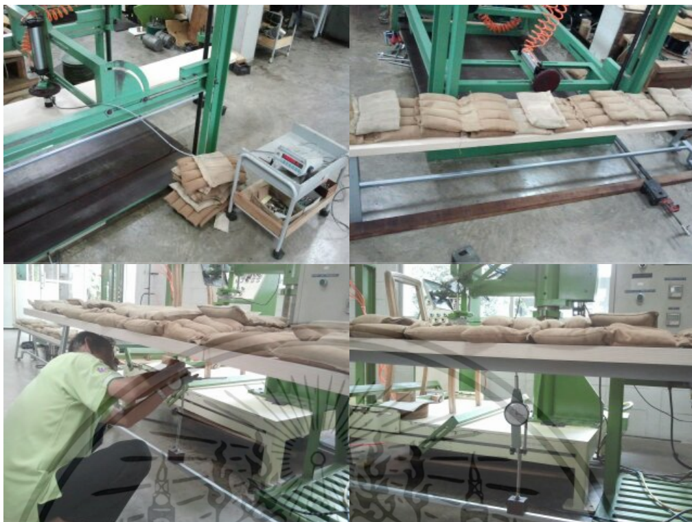
ภาพที่ 4.46 การทดสอบความแข็งแรงของชุดโต๊ะรับประทานอาหาร
