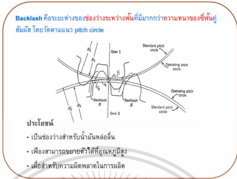
ภาพที่ 2.38 ส่วนประกอบเฟืองแบบตรง
