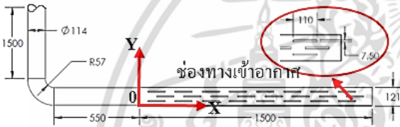
รูปที่ 2 ขนาดและลักษณะช่องทางเข้าของหัวดูดแบบเดิม
