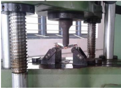
รูปที่ 6 3-point bending test
