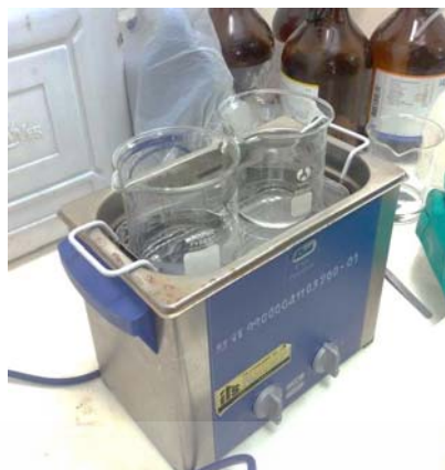
รูปที่ 3.6 ภาพแสดงเครื่องอัลตราโซนิคขณะกำลังทำความสะอาดแผ่นซิลิกอนด้วยอะซีโตน
