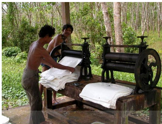
ภาพที่ 2.7 ภาพแสดงตัวอย่างการทำแผ่นยางพารา
