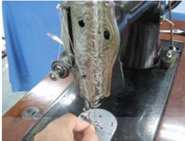
ภาพที่ 2.53 ด้ายลงไปยังลวดที่บังคับเข็ม ร้อยด้ายเข้าไปในรูเข็มจากด้านนอกไปยังด้านใน
