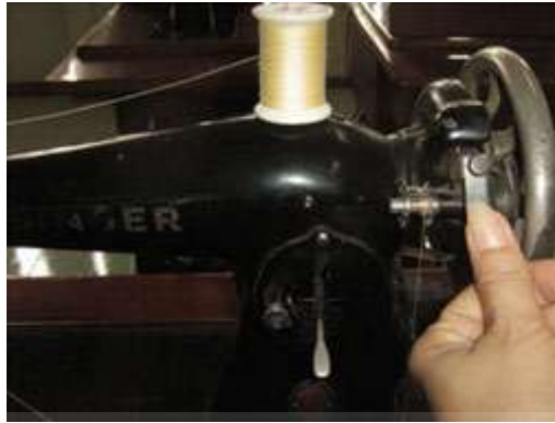
ภาพที่ 2.44 สวมใส่กระสวยเข้ากับแกนกรอด้าย
