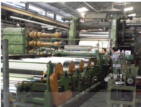
ภาพที่ 2.4 แสดงเครื่องอัดลายนูนแบบลูกกลิ้ง (Calendering)
