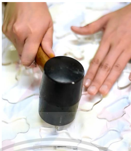
ภาพที่ 2.67 แสดงการใช้ค้อนยางทุบบล็อกอะคริลิกเพื่ออัดลายผ้า
