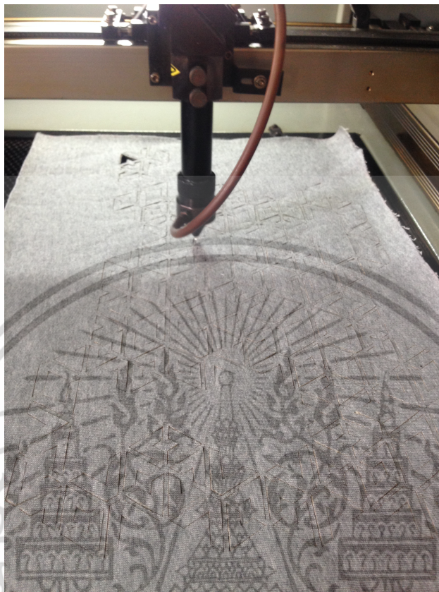
ภาพที่ 3.29 กระบวนการเลเซอร์คัท
