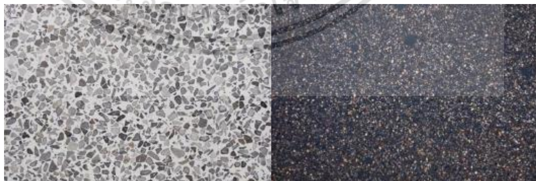
ภาพที่ 2.119 งานซีเมนต์และงานหินขัด (TERRAZZO)
