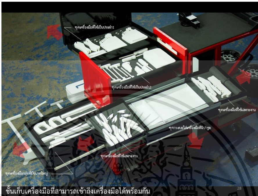
รูปที่ 4.2.28 : ภาพแสดงหุ่นจำลองขณะถูกเปิดลิ้นชักทุกชั้นเพื่อแสดงการเข้าถึงเครื่องมือได้พร้อมกัน
