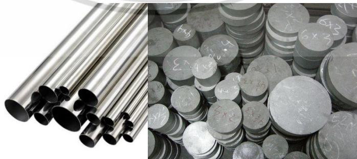
ภาพที่ 2.7 แสดงโลหะรูปพรรณจากอลูมิเนียมอัลลอยในลักษณะต่างๆ
