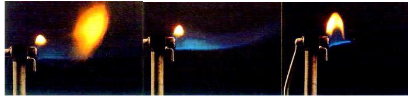
ภาพที่ 2.47 ประเภทของเปลวไฟ (รูปกลางเหมาะสมกับการเชื่อม)
