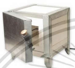
ภาพที่ 2.71 เตาอบที่ใช้ในการอบยาสี ใช้ในการลงยา
