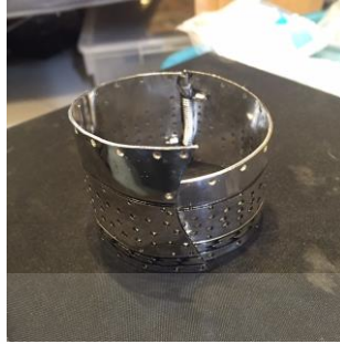
ภาพที่ 4.12 กำไลที่ถูกเจาะรูและประกอบสปริงแล้ว
