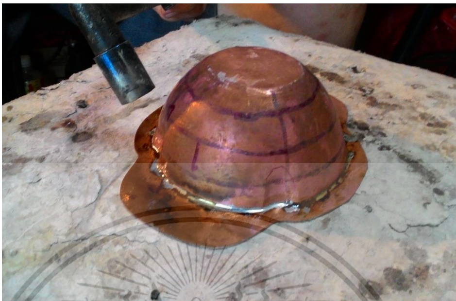
รูปที่ 55 แสดงการเชื่อมขอบเข้ากับตัวชิ้นงาน
