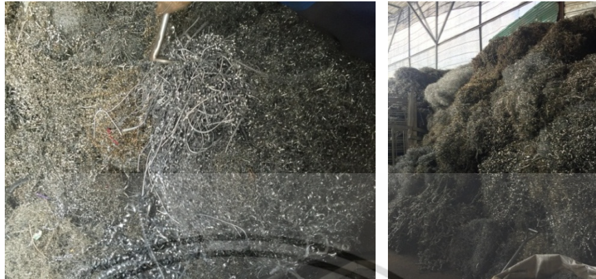
ภาพที่ 2.3-2.4 แสดงตัวอย่างเศษซึ่กสิ่งโลหะที่เหลือจากการผลิต
