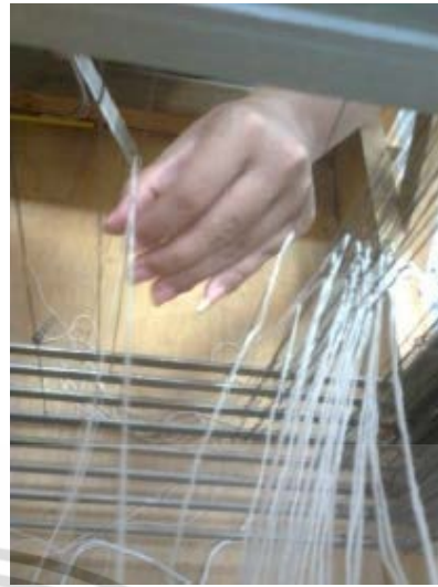
ภาพที่ 2.41-2.42 แสดงขั้นตอนการร้อยตะกอ
