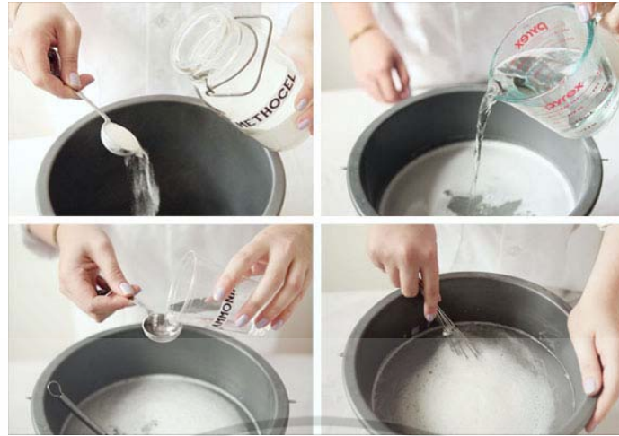
ภาพที่ 2.11 วิธีการผสมน้ำคาร์บอกซิเมทิลเซลลูโลสกับแอมโมเนียให้เข้ากัน
