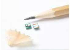
ขนาด 4.1 x 4.1 x 2.1 mm ต้องการกำลังไฟ 1.8v
