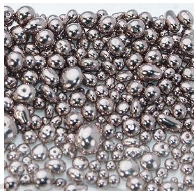
ภาพที่ 4.2 ตัวอย่างเม็ดเงินที่ใช้ในการหล่อ
