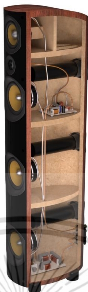
รูปภาพ 2-24 ภาพโครงสร้างภายในของ tannoy ที่มา : แฟ้มภาพของ นายเจษฎา เนินลพ
