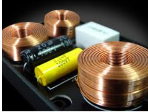
รูปภาพ 1-20 วงจรคออสโอเวอร์ภายในลำโพง ที่มา : ภาพที่ 1-17 ถึง 1-20 มาจากแคตตาล็อก ร้านสามดี ออดิโอ
