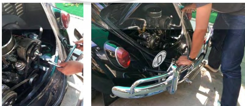
ภาพประกอบ 2.5.9 ภาพแสดงตำแหน่งและวิธีการหมุนเครื่องยนต์
