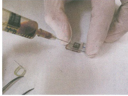
ภาพที่ 3.9 การเติมสารละลายอิเล็กโทรไลต์
