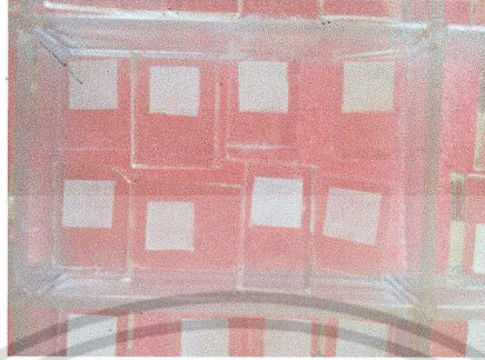
ภาพที่ 3.4 กระจกนำไฟฟ้าเคลือบด้วย ZnO
