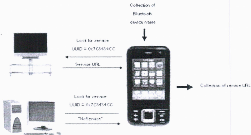
รูปที่ 3.3 แสดงขั้นตอนการทำงานของส่วนการค้นหบริการ
