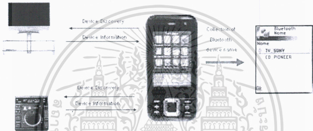
รูปที่ 3.2 แสดงขั้นตอนการทำงานของส่วนการค้นหาอุปกรณ์
