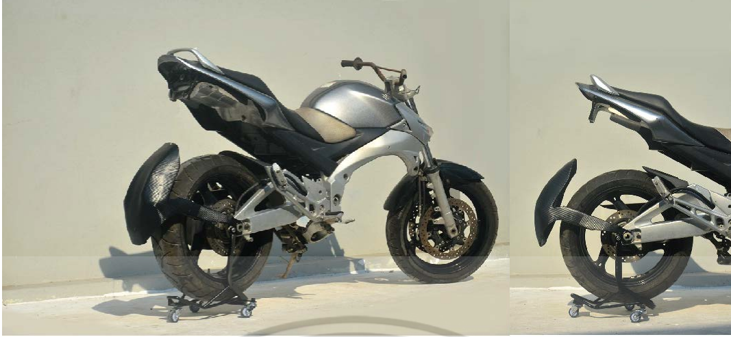
รูปที่ 4.5 : แสดงภาพอุปกรณ์เคลื่อนย้ายและบำรุงรักษารถจักรยานยนต์ขนาดใหญ่ขณะใช้งานจริง
