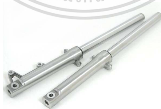
รูปที่ 2.12 โช้ครับน้ำหนักด้านหน้าแบบเทเลสโคปิค (Telescopic)
