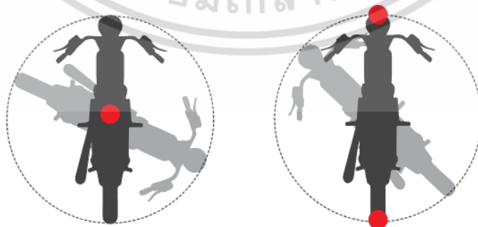
รูปที่ 2.31 แสดงลักษณะการเคลื่อนย้ายรถจักรยานยนต์ขนาดใหญ่ ในรูปแบบการจุดหมุนตรงกลาง
