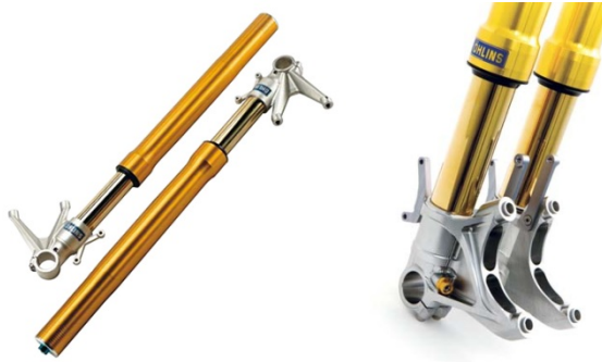
รูปที่ 2.13 โช้ครับน้ำหนัkd้านหน้าแบบกลับหัว (Upside-down fork)
