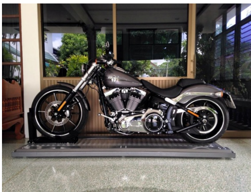
รูปที่ 2.66 สแตนดาร์ดเคลื่อนย้ายแบบฐานจอด
