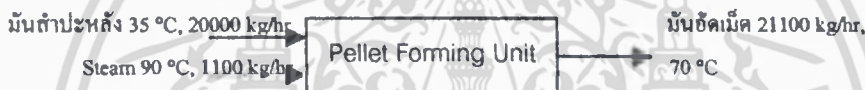
รูปที่ 3.4 แสดงมวลขาเข้า-ออกของเครื่องอัดเม็ดมันสำปะหลัง(Pellet Forming Unit)
