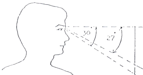
ภาพที่ 49 ความกว้างของมุมมองของคนโดยไม่ต้องหันศีรษะ
