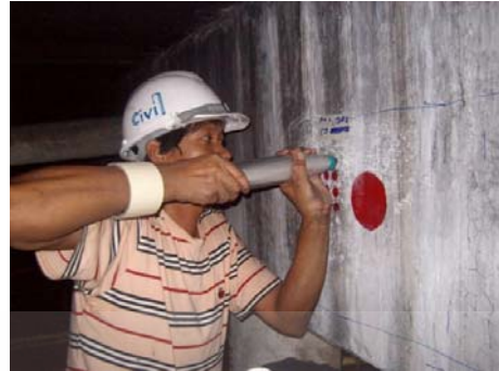
รูปที่ 4: แสดงการทดสอบ Rebound Hammer Test
