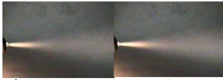
รูปที่ 4 กระแสของละอองลอยของน้ำแข็งแห้งที่ผลิตได้จากเครื่องรุ่น AFMS-100
