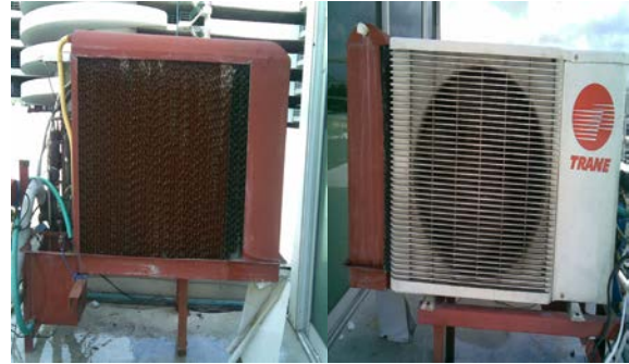
รูปที่ 4 แสดงลักษณะของชุดการทดลองและการติดตั้งให้กับชุดความแน่นของเครื่องปรับอากาศ
