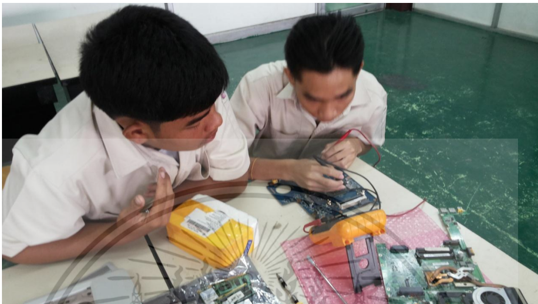
ภาพที่ จ.9 ทดสอบความสามารถหลักการซ่อมเบื้องต้นอาการเปิดไม่ติดและเปิดติดภาพไม่ขึ้นโดยวัด ลำดับแรงดันไฟ จำนวน 5 ขั้นตอน
