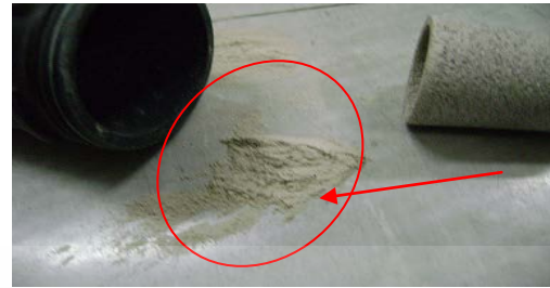
รูปที่ 6 Air Filter ที่มีฝุ่นปนมากับลม
