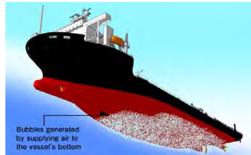
รูปที่ 5 Air lubrication บริเวณใต้ท้องเรือ [11]
