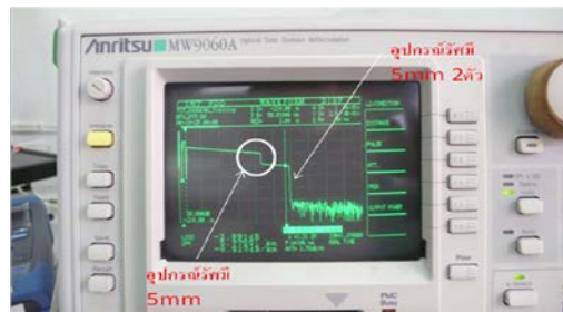
รูปที่ 10 กราฟที่ได้จาก OTDR ที่ใส่อุปกรณ์รัศมี 5 มิลลิเมตร เปรียบเทียบกับ อุปกรณ์รัศมี 5 มิลลิเมตร ที่มีส่วน 2 โค้ง
