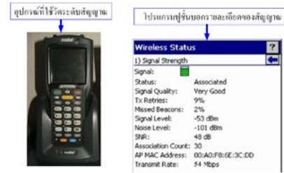
รูปที่ 6 โปรแกรม Fusion ที่ติดตั้งอยู่บน Symbol MC3090 การทดสอบตัวแปรมีรายละเอียดดังนี้
