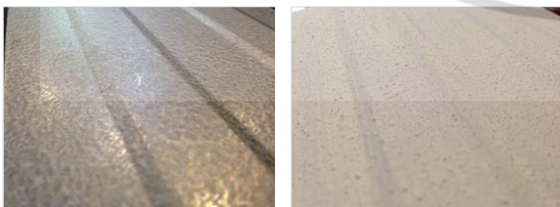
รูปที่ 1: ลักษณะพื้นผิวของหลังคา ก่อนเคลือบและหลังเคลือบด้วยสีสะท้อนรังสีแสงอาทิตย์
