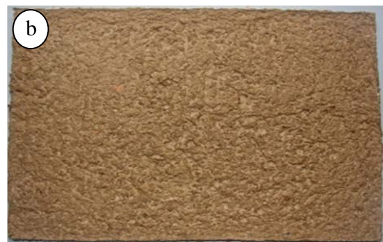
ภาพที่ 3 ลักษณะของวัสดุดูดซับเสียงที่ทำจากลึงกระดาษผสมกับกระดาษเหลือใช้
