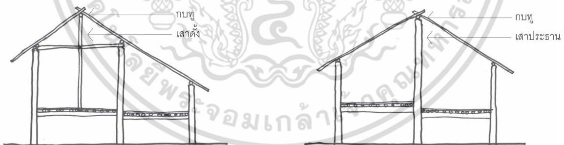
รูปที่ 6 จั่วเรือนที่กบทุวางบนเสาดั้ง (ซ้าย) และจั่วเรือนที่กบทุวางบนเสาประธาน (ขวา) ที่มา: รวบรวมข้อมูลโดยผู้วิจัย
