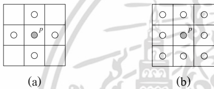
รูปที่ 6: (a) แพทเทิร์นแบบ 4-connected ซึ่งเป็นแพทเทิร์นที่พิจารณาใน 4 ทิศทางของจุดภาพ, (b) แพทเทิร์นแบบ 8-connected ซึ่งเป็นแพทเทิร์นที่พิจารณาใน 8 ทิศทางของจุดภาพรอบจุดกึ่งกลางแพทเทิร์น
