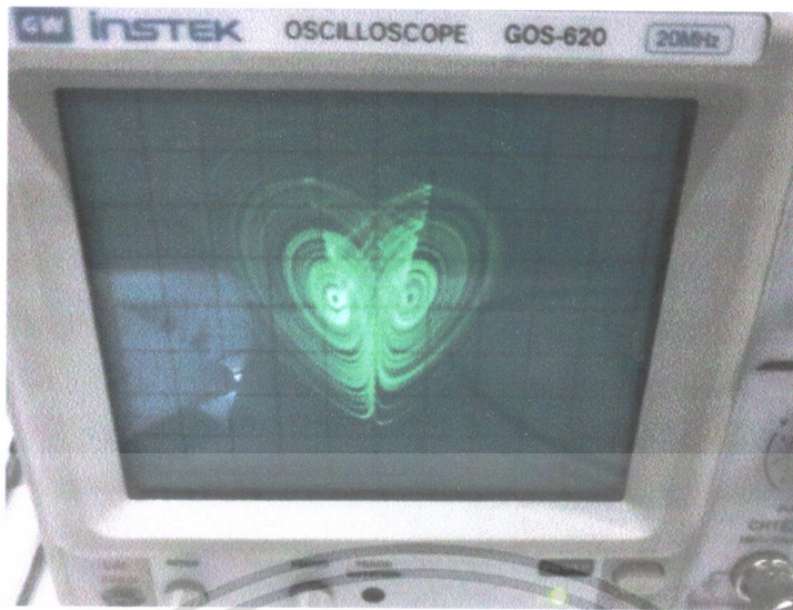
รูปที่ 2.17 กราฟค่า x-z ที่ได้จากออสซิลโลสโคป
