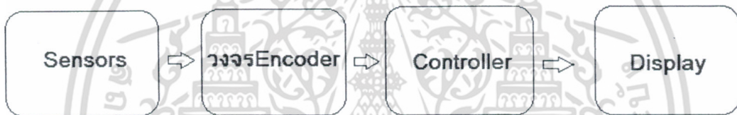
รูปที่ 3 บล็อกไดอะแกรมของระบบลานจอดรถอัจฉริยะ
