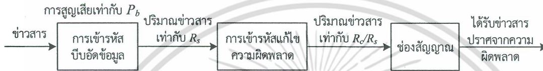
รูปที่ 2.6 การเข้ารหัสบีบอัดข้อมูลแบบสูญเสียและเชื่อมต่อการเข้ารหัสแก้ไขความผิดพลาด
